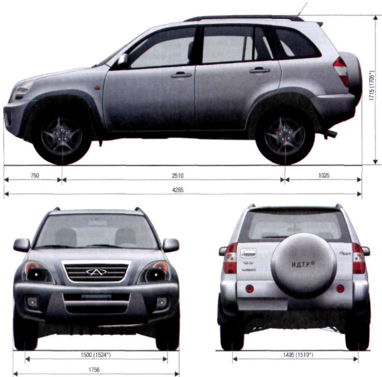
Рис. 1.1. Габаритные размеры автомобиля (*Автомобили с колесами 235/60 R16).
