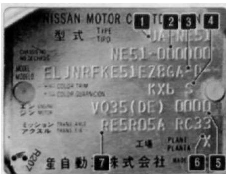
Рис. 1.5. Идентификационная табличка: 1 - тип кузова; 2 - идентификационный номер автомобиля (кузова); 3 - обозначение (код) модели; 4 - код цвета автомобиля, салона; 5 - модель (комплектация) двигателя; 6 - модель трансмиссии; 7 - модель автоматической коробки передач
